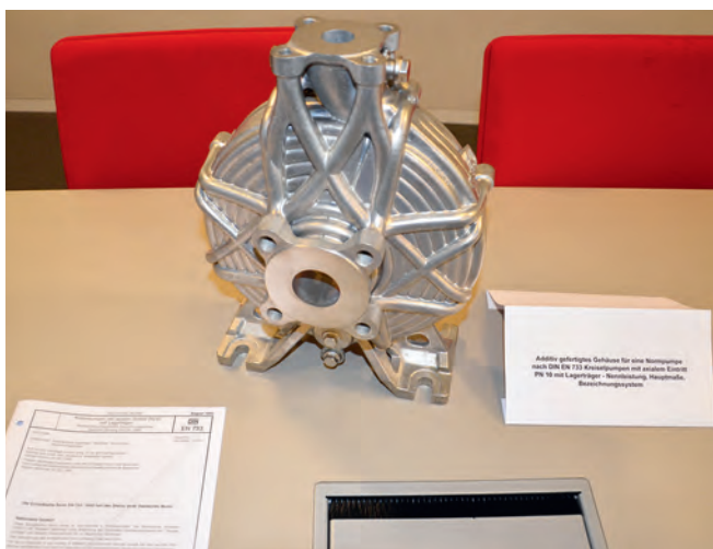
Additiv gefertigtes Gehäuse für eine Normpumpe nach DIN EN 733 Kreiselpumpen mit axialem Eintritt PN 10 mit Lagerträger – Nennleistung, Hauptmaße, Bezeichnungssystem
