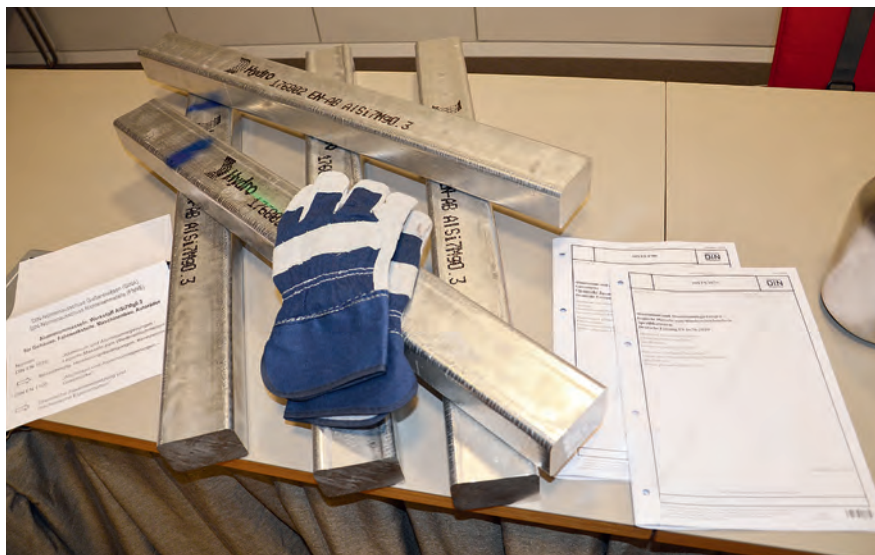
Aluminiummasseln, Werkstoff AlSi7Mg0.3 für Gehäuse, Fahrwerksteile, Maschinenbau, Autoräder
