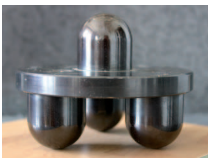
Abb. 2: „Drei-Ball-Prüfgerät“ für Stoßprüfung gemäß CTBA-Prüfvorschrift
