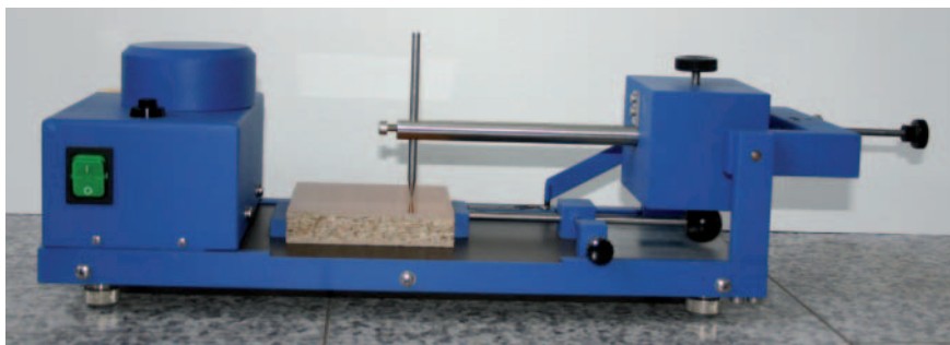
Abb. 1: Lineares Kratzgerät Erichsen, Modell 239-2
