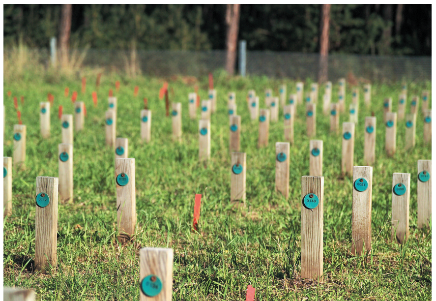
Freilandtest von Holzschutzmitteln im Erdkontakt nach EN 252
