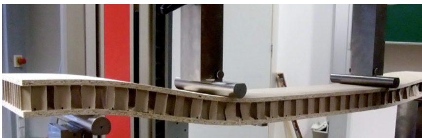
Abb. 1: Verformungsverhalten eines leichten Sandwichwerkstoffs bei einer Vier-Punkt-Biegeprüfung
