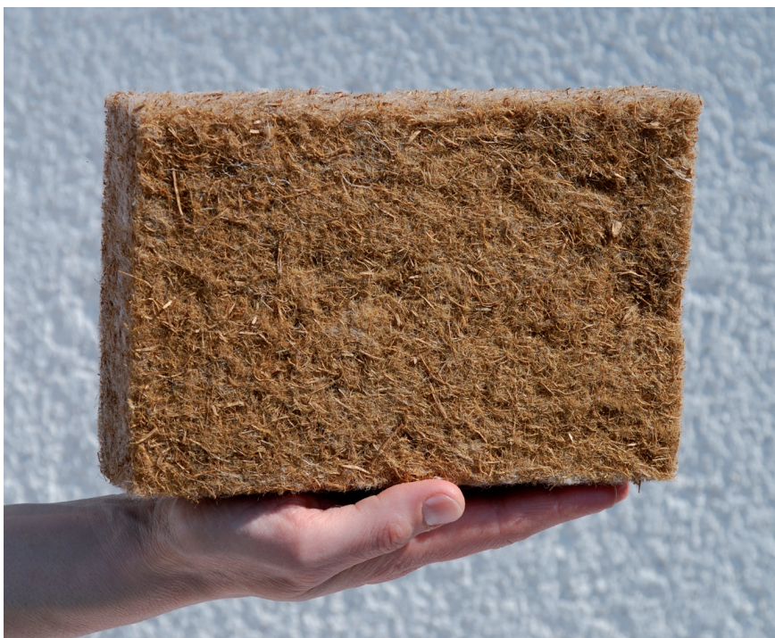
Gefachdämmstoff aus einem Gewirk miteinander verwobener Holzfasern (© A. Zielke/VHD e.V., Wuppertal)
