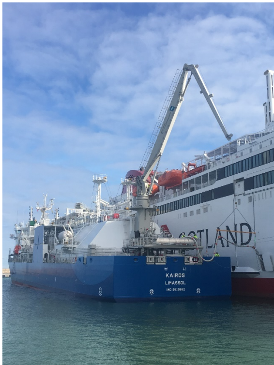
Schiff bei der Betankung mit LNG. Foto: © Nauticor
