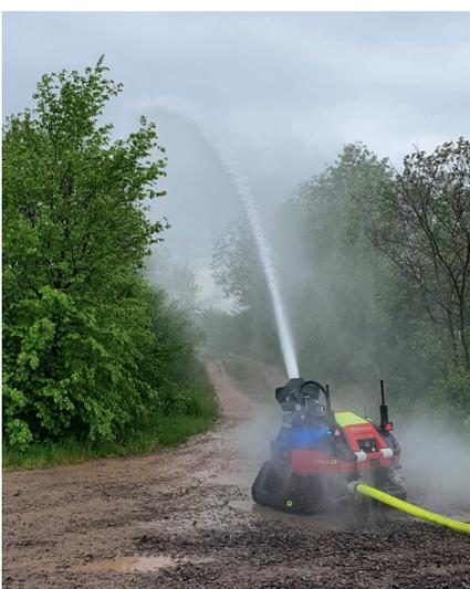
Beispiel eines auf Sicht gefahrenen Kettenfahrzeugs mit einem fernbedienten Werfer, gespeist über einen Schlauch. Foto: Zawadke
