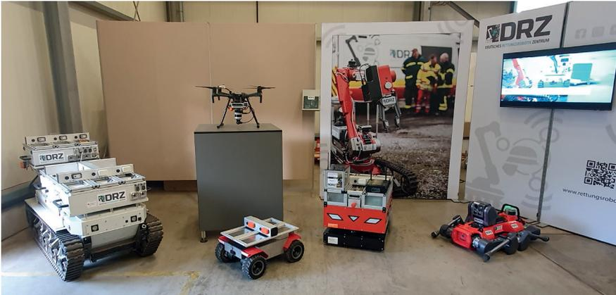
Verschiedene Roboter des DRZ: im Vordergrund links der GARM, in der Mitte zwei Versuchsmuster für den Indoor-Einsatz, rechts der Schreitroboter ANYmal, dahinter ein UAV (Drohne) und auf dem Plakat der DRZ-Manipulator TIM.
