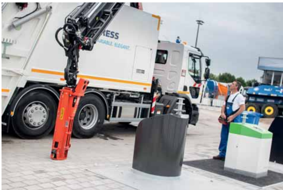
Behälteridentifikation mittels Hubzapfenaufnahme eines Unterflurbehälters © NKT Geschäftsstelle
